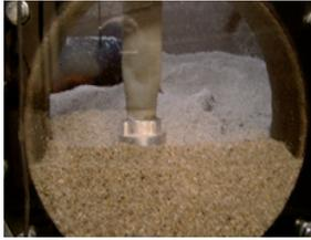
Filter wird mit Sand gefüllt
