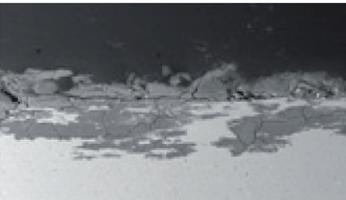
Korrosion entlang der Korngrenzen des Metallgefüges.
