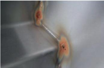
Örtlicher Korrosionsvorgang, der zu kraterförmigen, nadelstichtartigen Vertiefungen und am Ende zur Durchlöcherung führt.
